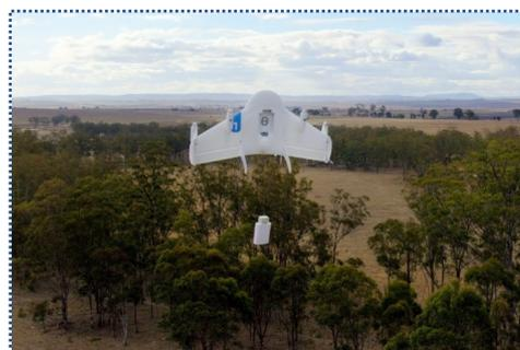
機体尾部を下にした縦置き状態からプロペラを使って垂直に離陸し、空中で向きを変えて水平に滑空するグライダーだ。最終的に白い発泡材とプラスチック製の幅約3.5フィート（約1.06メートル）、重さ18ポンド（約8.2キロ）のグライダーが完成した。だがそれまでには試作機を何度も作り直す必要があった。（アメリカ軍の最新鋭輸送機のオスプレイと同様の発想）
